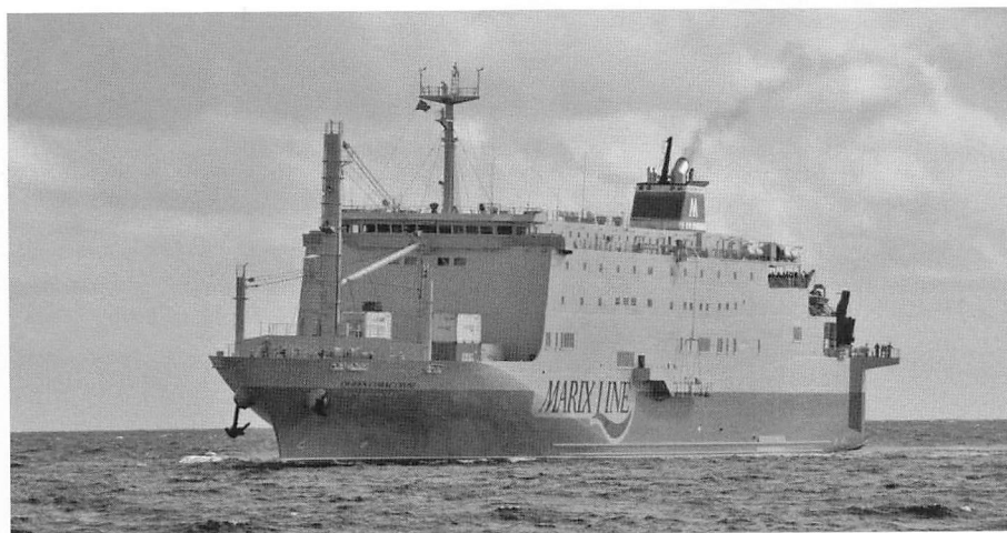
与論島に入港する「クイーンコーラルクロス」。船尾からはRORO荷役、船首のデッキ上には10フィートコンテナをデリックを使ってLOLO(Lift on-Lift off)荷役する。
